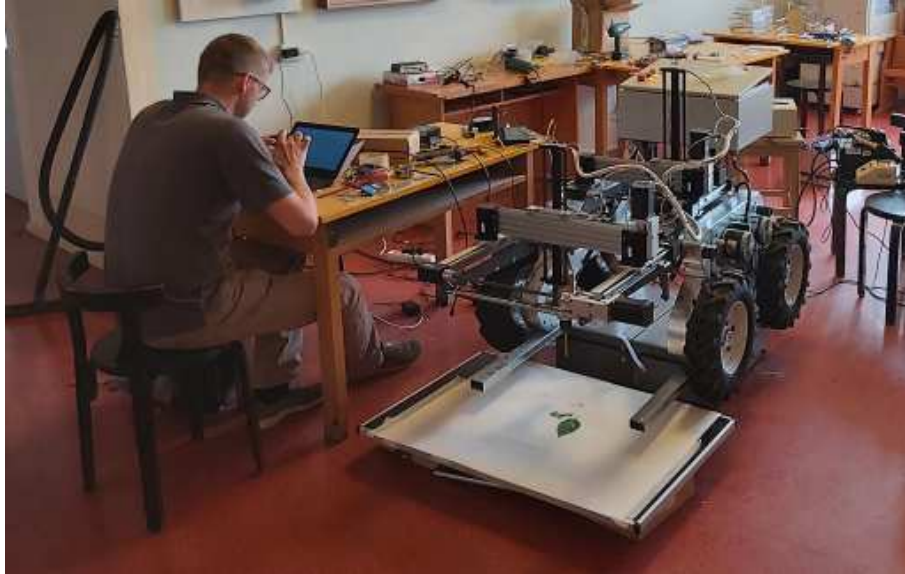
114. att. Nezāļu ierobežošanas agregātu kalibrēšana
