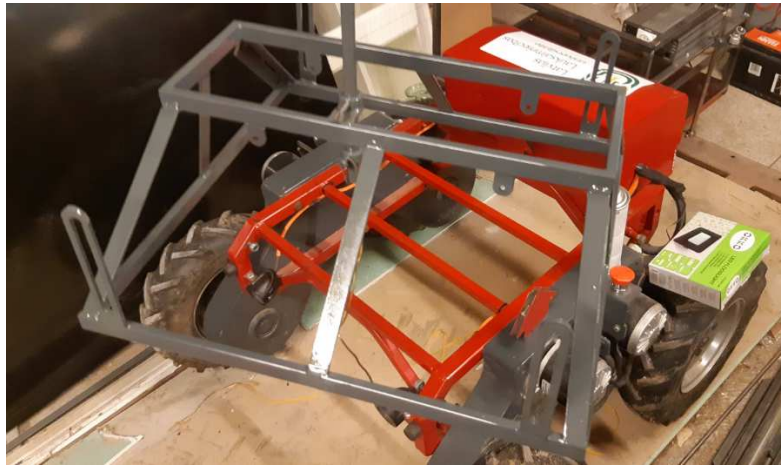
8. att. Kameras un apgaismojuma stiprināšanas rāmja izveide
