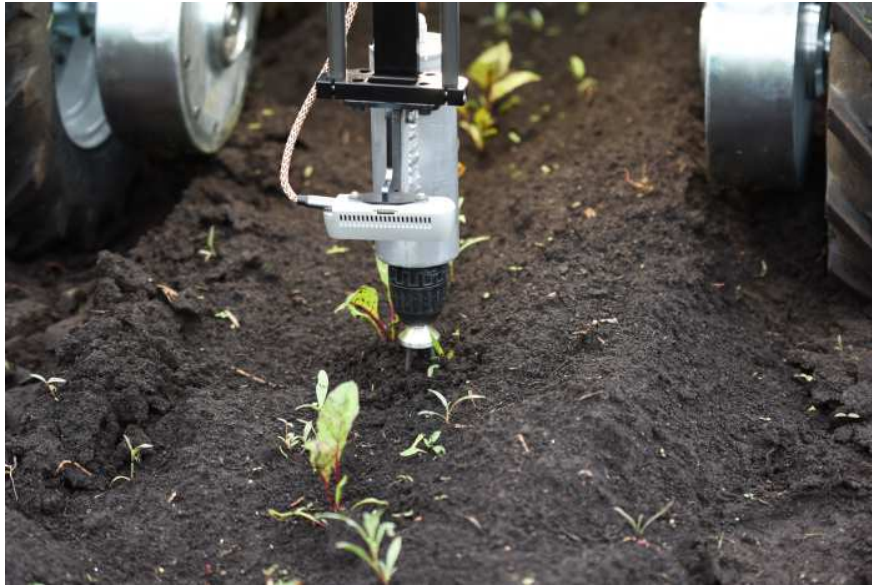
121. att. Mehāniskā nezāļu ierobežošanas rīka darbība lauka apstākļos
