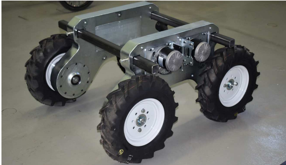
108. Att. Nezāļu iznīcināšanas robota braucamā daļa bez elektronikas
