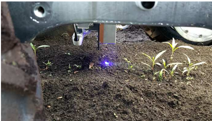
122. att. Lāzera nezāļu ierobežošanas rīka darbība lauka apstākļos
