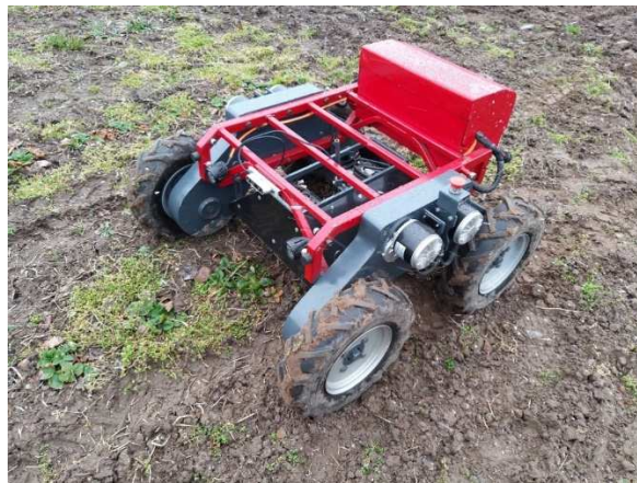
66. att. Pašgājēja fotografēšanas platforma aprīkota ar kamerām un saules aizsegumiem
