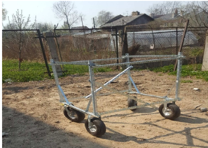
63. att. Stumjamās fotografēšanas platformas karkass
