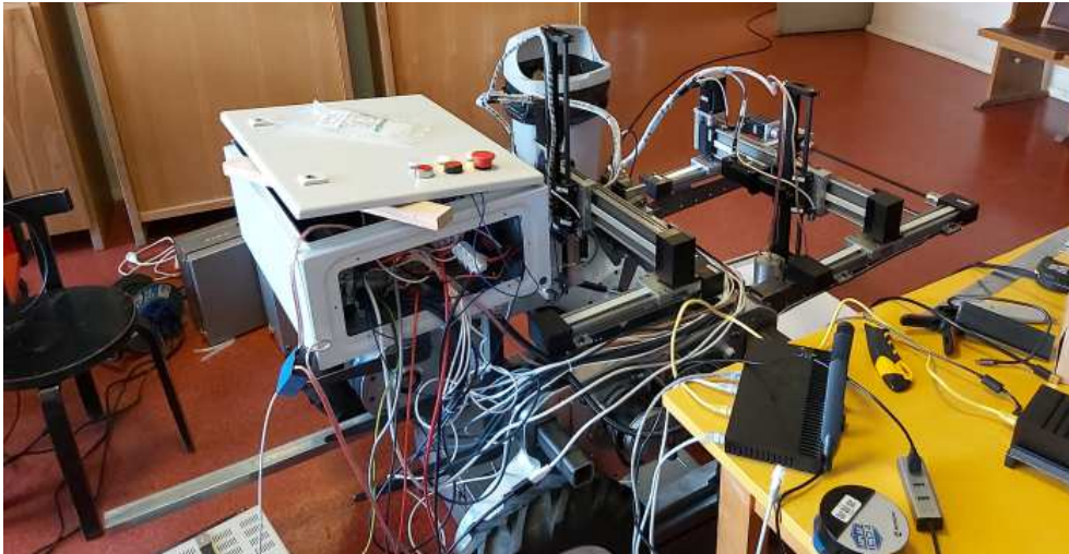
110. att. Robota vadības elementu integrēšana un elektroinstalācijas darbi
