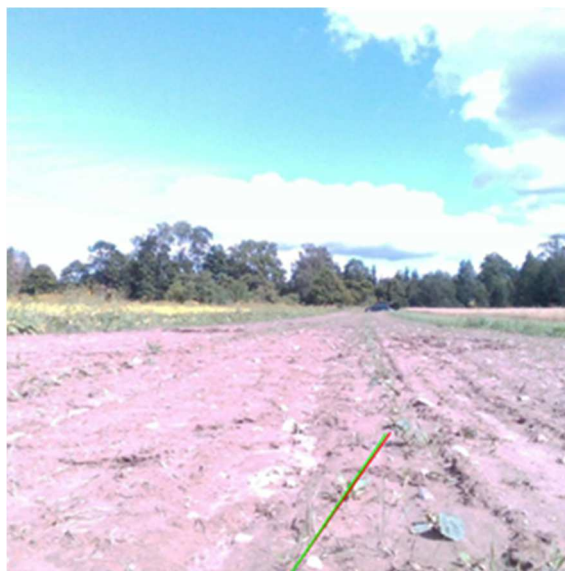
97. att. No robota kameras frontāli uzņemts lauka attēls, zaļā līnija, - robota kustības virziens, sarkanā līnija, - vagu atpazīnēja ieteiktais robota griešanās virziens
