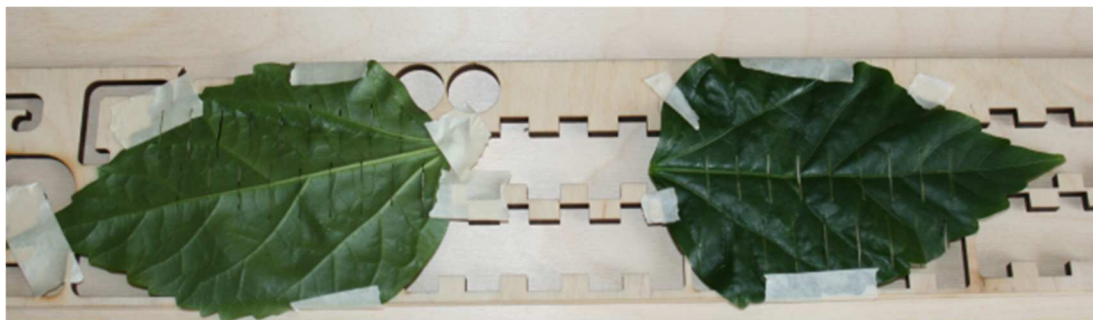
39. att. Lapu apstrādes eksperiments ar ražotājs BODOR 150 W CO 2 lāzeri (10600 nm viļņa garums, 20% jauda)
